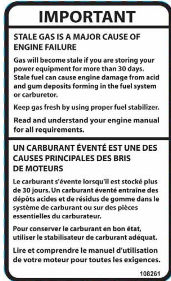
Décalque #108261 Recommandations sur le carburant pour éviter des bris de moteur.
